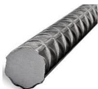
El acero corrugado, es una clase de acero laminado con unos resaltes que hacen que se adhieran mejor al hormigón. Son aceros de alta ductilidad (se pueden cortar y doblar con mayor facilidad), diseñados para evitar posibles roturas frágiles en la estructura del hormigón como las sometidas a influencias sísmicas, dinámicas o de impacto. Aportan un elevado grado de seguridad a la construcción final. Está diseñado especialmente para construir elementos estructurales de hormigón armado.
